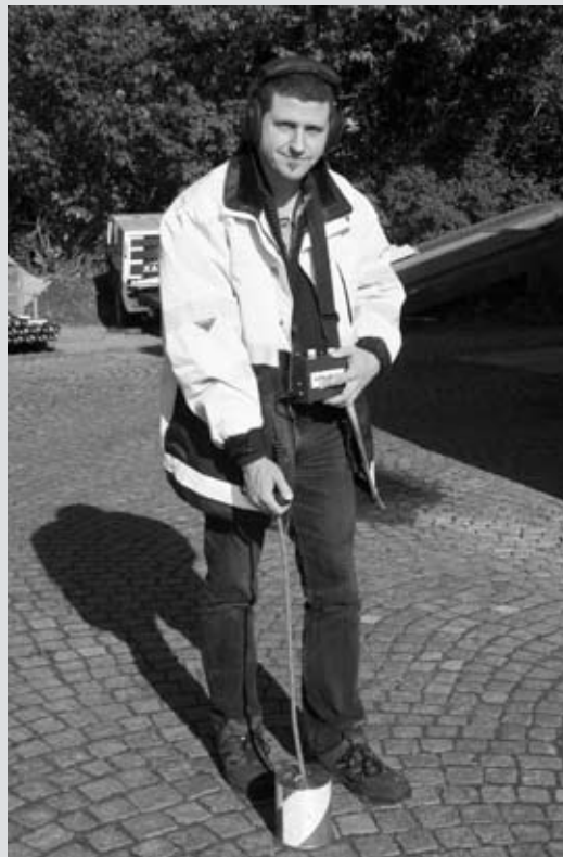
Maskinmester Ulf Nyborg viser, hvordan man med moderne måleudstyr er i stand til at finde årsagerne til vandspild. Med jordmikrofonen kan man lytte sig frem til endog meget små lækager 1,5 meter nede i jorden. 2006.
